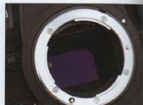
▲ D3的FX格式全片幅CMOS感光元件，有效像素為1210萬。
