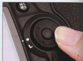
▲ 機背的多功能控制器可用來直接選擇自動對焦點。
