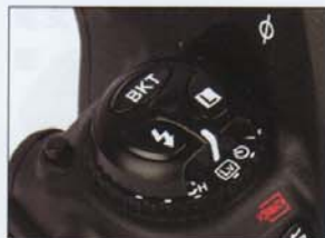
▲ D3一樣支援Live View實時拍攝功能，而上面的「L」按鈕則可用來鎖定快門或光圈值（視拍攝模式而定）。
