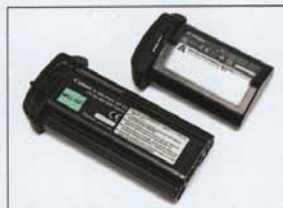
▲EOS-1D Mark III改用全新設計的鋰離子電池LP-E4，圖中為新舊「1仔」電池在體積上之比較。(上：LP-E4；下NP-E3)
