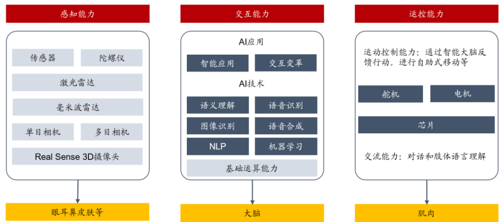
图3：人形机器人三大核心模块
