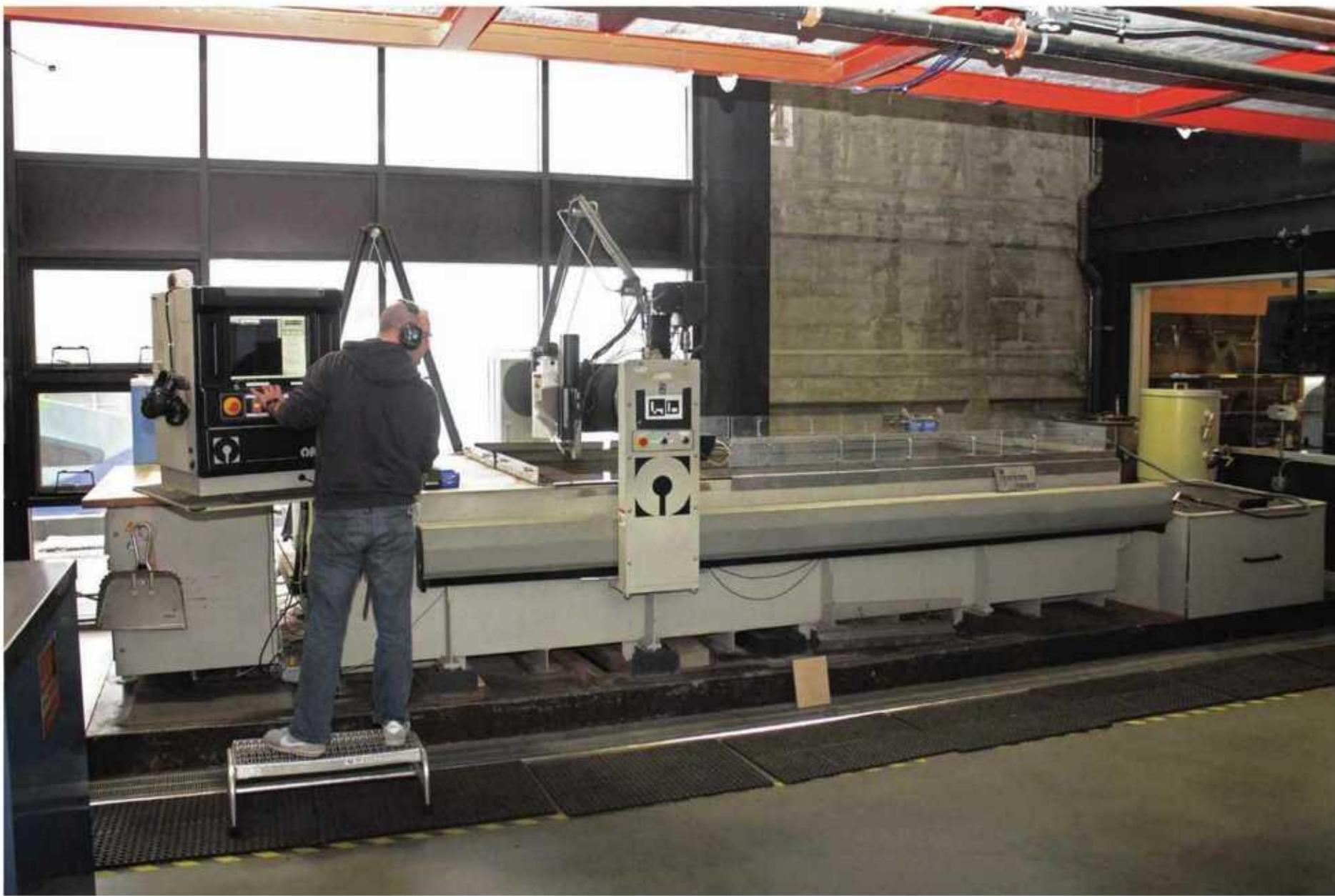
水射流的大小约为 $4\text{ m}\times 3\text{ m}$ ，而水池的尺寸是 $6\text{ m}\times 5\text{ m}$ 。我站在一个小踏板上操纵机器。当时我正守在计算机操纵装置旁，准备在发生意外时按下紧急停止键。如果你想更靠近切割头来观察的话，我右侧的金属架柱上有一套副控制装置。照片右后方的黄色压缩罐，会把储存在其中的石榴石输入送料斗。金属架柱上黑色的机械臂和细长的银管，会从一个高压泵（在我大腿左侧的柜子里）中将水注入切割头。
