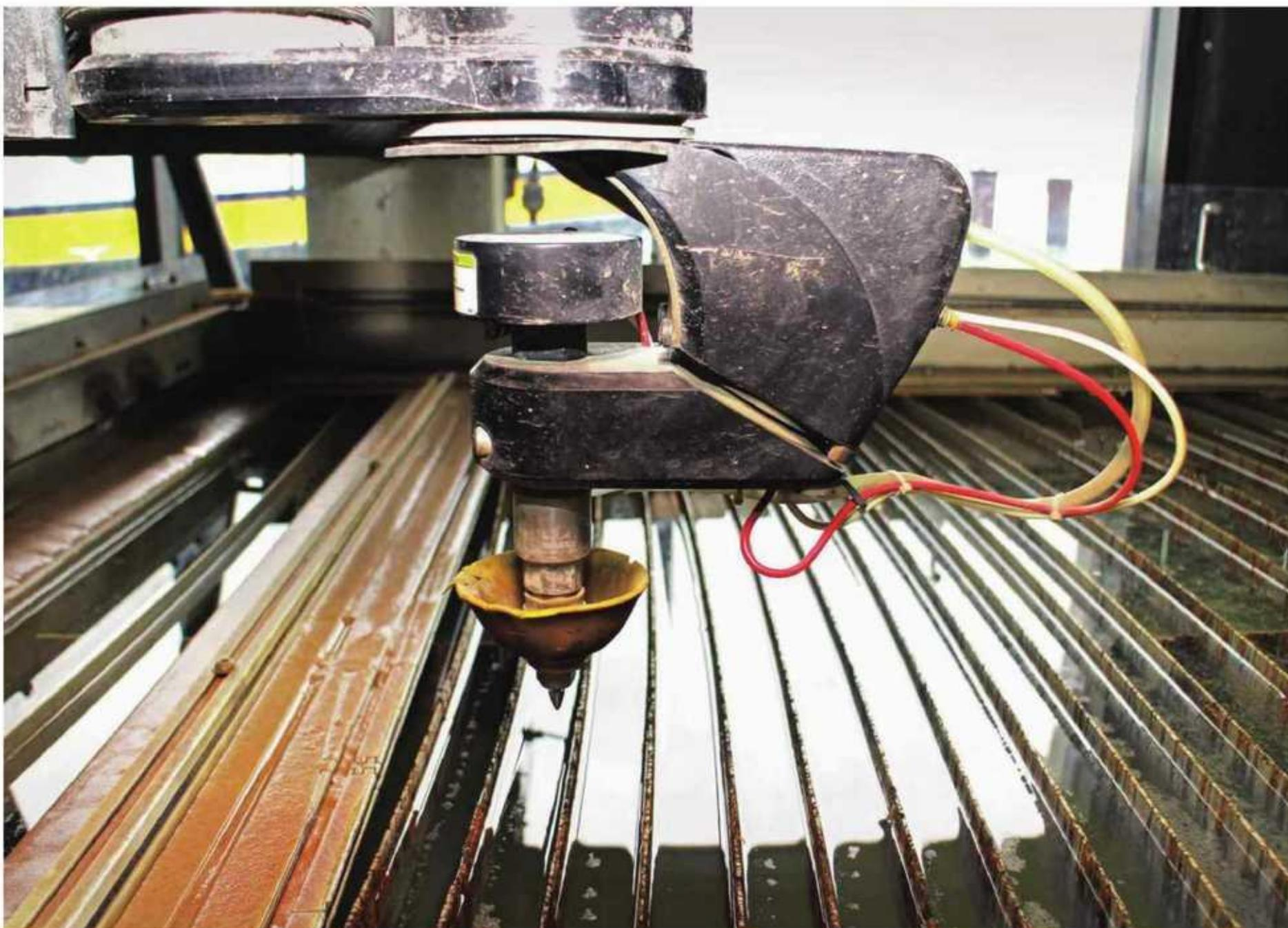
水池上方处于静止状态下的切割头。黄色杯状物是一个橡胶保护罩。它在工作时通常是向下翻的，这里向上翻为的是展示切割喷嘴。要被切割的平整材料会被固定在底座的板条上，而且在常规操作时，水池的水位会上升，以覆盖材料，同时切割喷嘴会在材料上方高一点的位置移动。水池有助于消散水射流切割时产生的能量。粗管会把石榴石从上方的送料斗里注入喷嘴。
